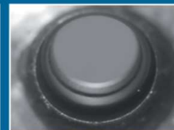
Tiefer Ziehring Materialablagerung in Winkel und Ziehkanal
