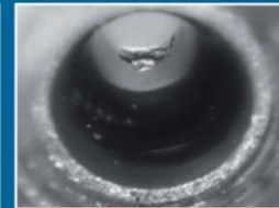
Tiefer Ziehring Materialablagerung in Winkel und Ziehkanal
